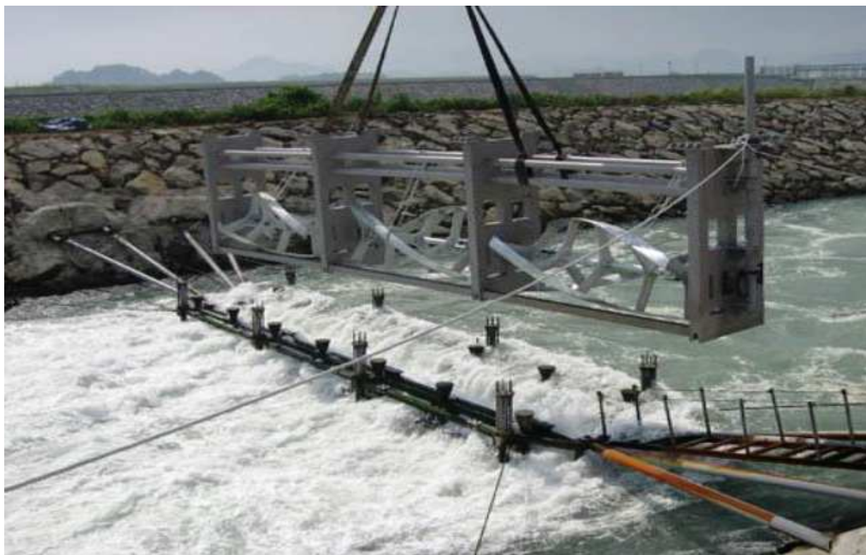
Рис. 3. / Fig. 3. Один из проектов геликоидного генератора / One of the projects of the helicoid generator
