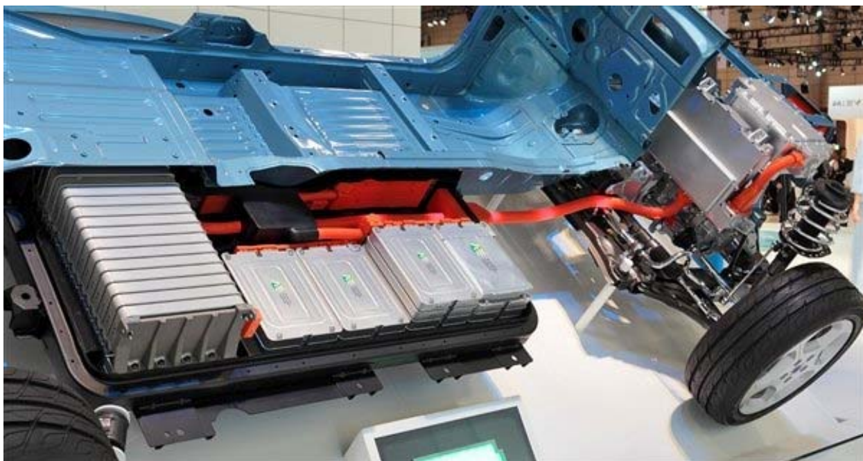
Рис. 1. Монтаж аккумуляторных батарей на электромобиль [7]
