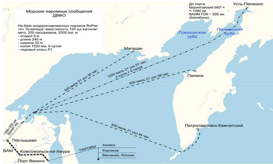
Рис. 7 / Fig. 7. Судоходные линии железнодорожных паромов, предложенные В.С. Збарашенко. Примечание: карты в границах 2014 г. / Shipping lines of railway ferries proposed by V.S. Zbarashchenko [14]
